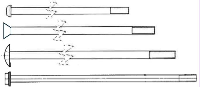
胴太材の場合、50mm程度まで弊社ヘッダー機でネジ転造下径に絞り加工可能です。
